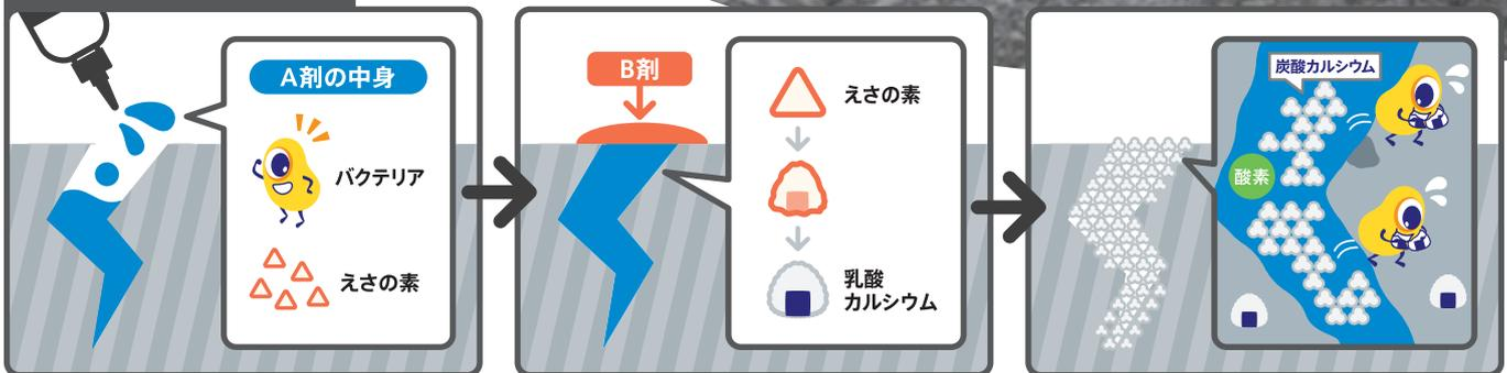
“バクテリア”と“えさの素”が入ったA剤をひび割れに塗布する。
